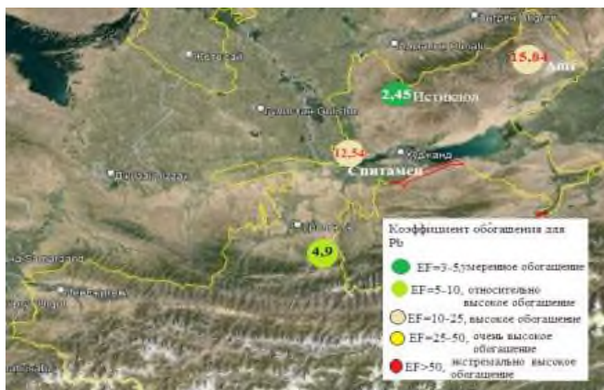
Рис. 2. Географическое распространение EF для Pb в пробах аэрозольных частиц. Цвет кружков представляет степень обогащения
